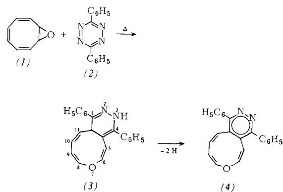
Durch ca. zweitägiges Einwirken von (2) auf überschüssiges (1) in 1,4-Dioxan bei 105°C entsteht das Cycloaddukt (3), ein luftempfindliches gelbes Pulver, in 27 % Ausbeute [bezogen
